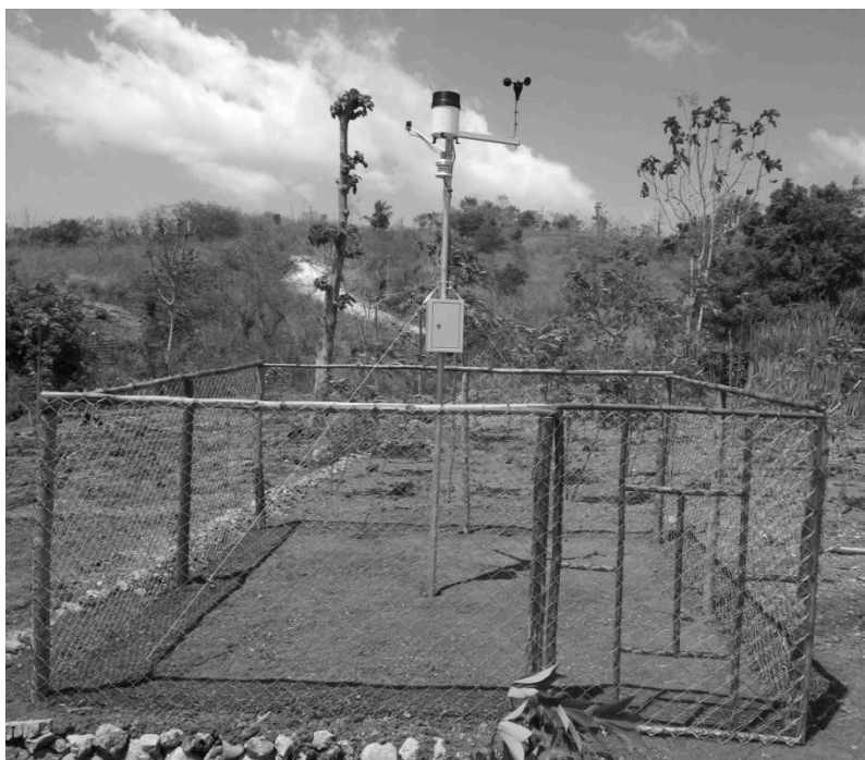
Figura 47. Mikro Hobo automátika ba estasaun meteorolojia iha fatin OFDT ida iha Balibo ne'ebé sukat kona-ba udan been, temperatura, umidade, radiasaun loro-matan no velocidade anin.
